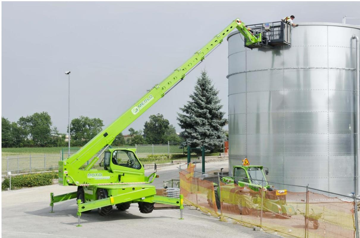
© MERLO Diese Arbeit darf auch ein auf einer Gelenktelekopbühne ausgebildeter Hubarbeitsbühnen-Bediener verrichten.
