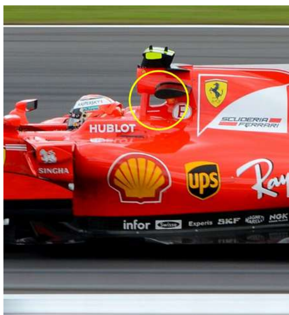
Ausreichend tragfähiger Anschlagpunkt zur Bergung an einem Fahrzeug von 2017 ohne Halo
