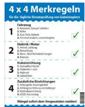
Abb. 3: Diese Checkliste zur täglichen Einsatzprüfung kann als Aufkleber direkt am Gabelstapler angebracht werden (© Resch-Verlag)
