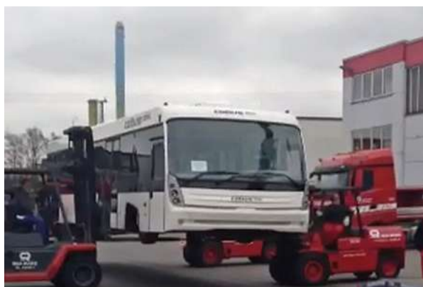
Quertransport eines Busses mit 4 Staplern. Hier ist absoluter Gleichtakt angesagt
