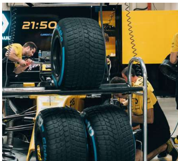
„Full Wet“ Formel-1-Reifen mit Profil
